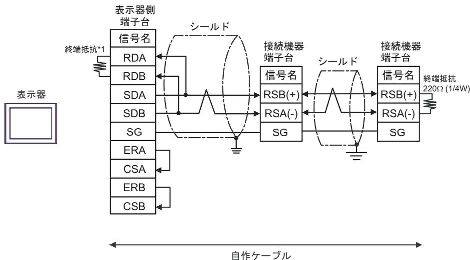
\*1 表示器に内蔵している抵抗を終端抵抗として使用します。表示器背面のディップスイッチを以下のように設定してください。
