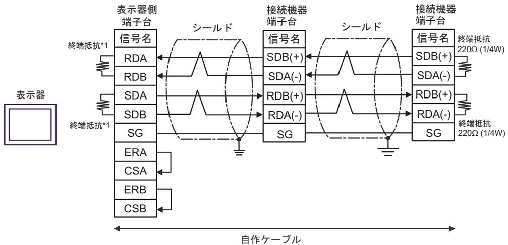
\*1 表示器に内蔵している抵抗を終端抵抗として使用します。表示器背面のディップスイッチを以下のように設定してください。
