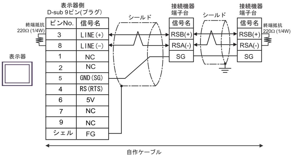
**重要** • 表示器の5V出力(6番ピン)はSiemens製PROFIBUSコネクタ用電源です。その他の機器の電源には使用できません。
