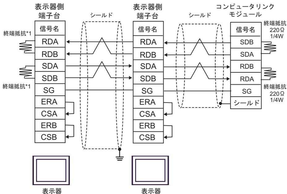
\*1 表示器に内蔵している抵抗を終端抵抗として使用します。表示器背面のディップスイッチを以下のように設定してください。
