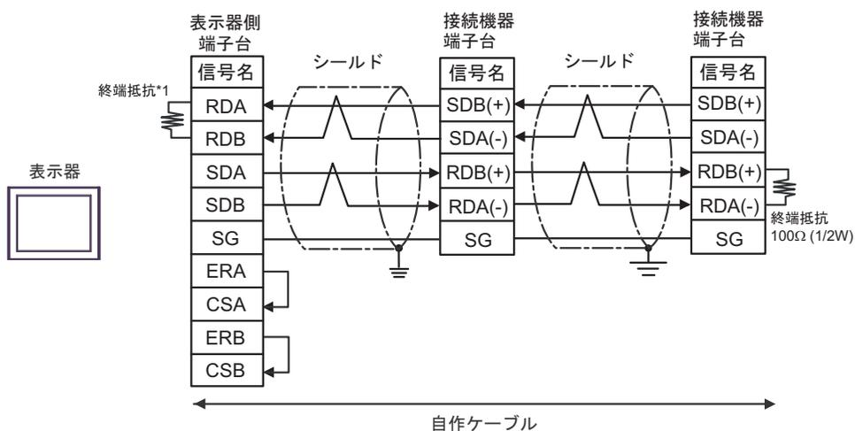
\*1 表示器に内蔵している抵抗を終端抵抗として使用します。表示器背面のディップスイッチを以下のように設定してください。
