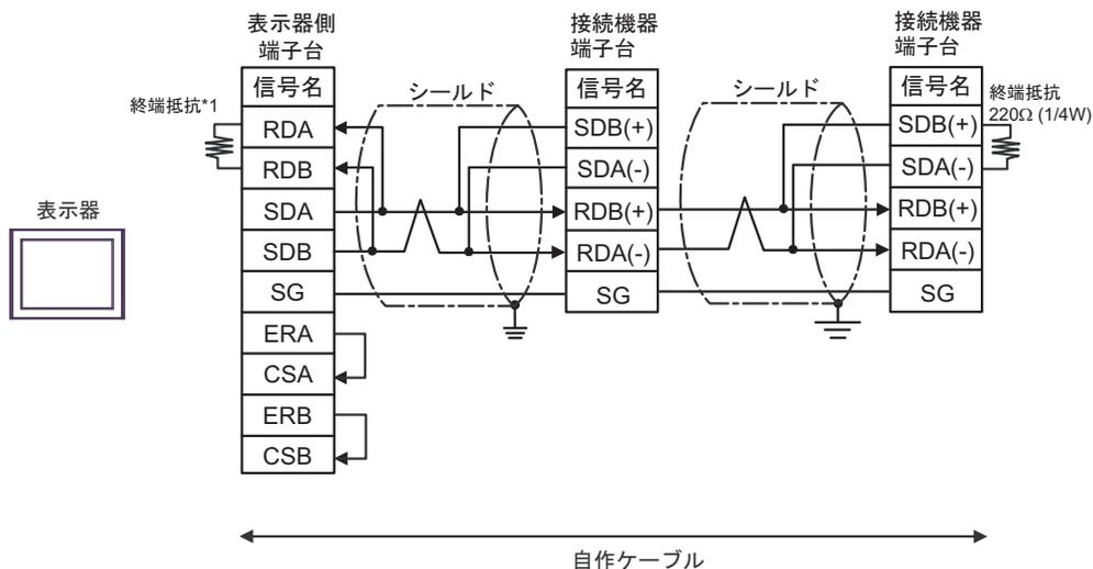
\*1 表示器に内蔵している抵抗を終端抵抗として使用します。表示器背面のディップスイッチを以下のように設定してください。
