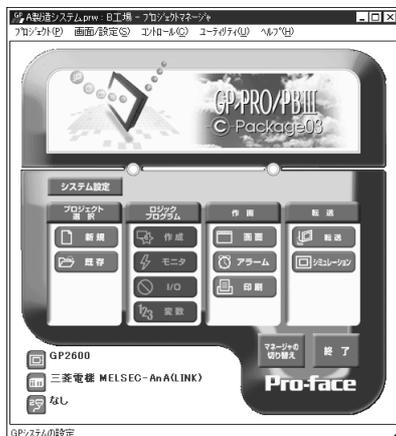
コメントを入力し、GP タイプ、シリアル I/F 切替、接続機器を選択します。必要に応じて拡張 SIO 設定も行います。
