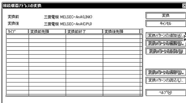
「アドレスタイプ」、変換前の接続機器の使用可能な「先頭アドレス」と「終了アドレス」および変換後の接続機器の使用可能な「先頭アドレス」を指定し、
