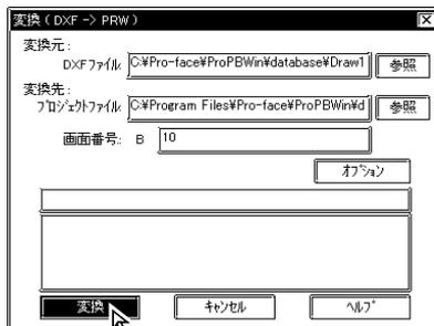
変換が終了したら、**キャンセル** で[DXF<->PRW コンバータ]に戻ります。
