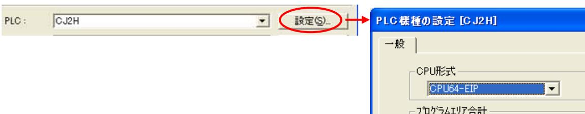
【PLC リスト】の【閉じる】を選択してください。選択しますと下のメッセージが表示されますので、【はい】を選択します。
