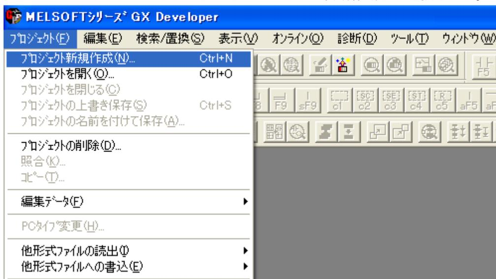
【プロジェクト新規作成】のウィンドウが表示されますので、【PCシリーズ】と【PCタイプ】を設定します。設定が終われば、【OK】を押してウィンドウを閉じます。
