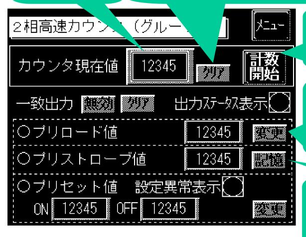
計数開始でカウントを開始します。動作中は計数中と表示します。
