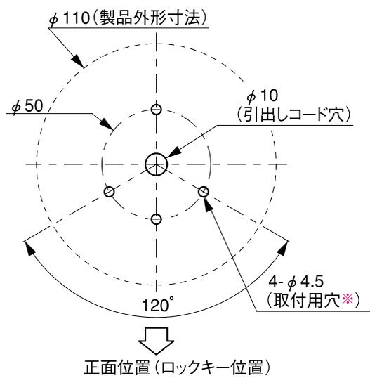
※ ボルト・ナット/小ネジなど使用の場合、長さは(8mm+取り付ける板厚)以上をお使いください。
