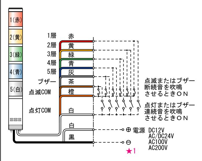
★1電源に極性があるのはDC12Vのみです。 ★2上記結線例では、点灯・点滅または、ブザー連続音・断続音 を同時入力の場合、点灯または連続音が優先し、他の段の 点滅またはブザー断続音の吹鳴ができなくなります。
