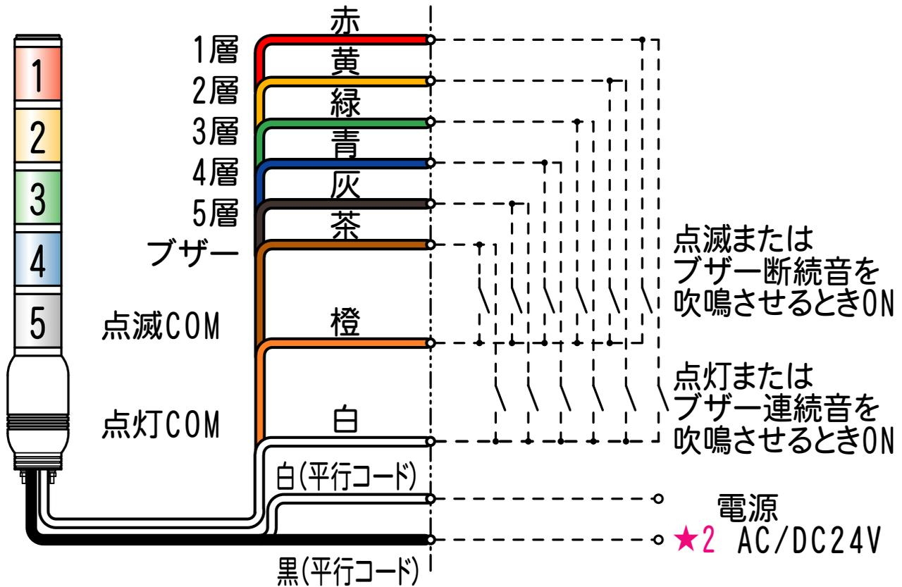
★1 上記結線例では、点灯・点滅または、ブザー連続音・断続音を同時入力の場合、点灯または連続音が優先し、他の段の点滅またはブザー断続音の吹鳴ができなくなります。
