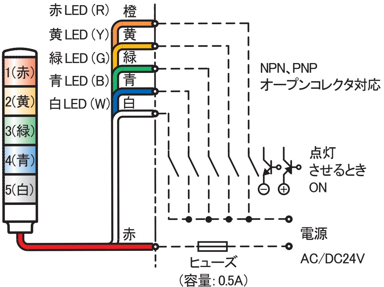
★上記結線例では、点灯・点滅または、ブザー連続音・断続音を同時入力の場合、点灯または連続音が優先し、他の段の点滅またはブザー断続音の吹鳴ができなくなります。
