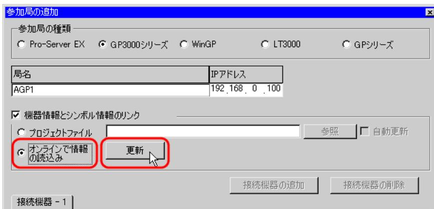
「オンラインで情報の読み込み」画面が表示され、手順4で入力したIPアドレスのGPと通信を開始します。GP3000、WinGP および LT3000 側はオフラインに移行せず、オンラインで読み込みを行います。
