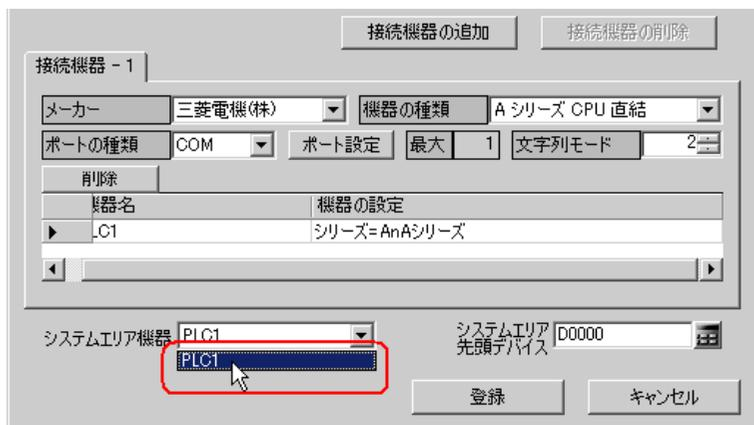
10 [ システムエリア先頭デバイス ] に、割り当てるシステムエリアの先頭デバイスアドレスを入力します。( GP3000 シリーズ、 WinGP および LT3000 の場合のみ )
