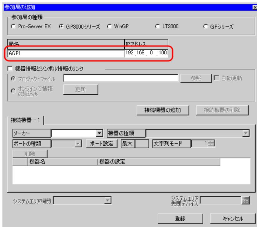
5 [メーカー] [機器の種類] および [ポートの種類] のリストボタンをクリックし、接続機器の設定を行います。
