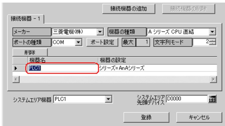
**MEMO** ・ 接続機器の名称、種類、設定を『GP-Pro EX』で設定した内容と完全に一致させてください。不正なデバイスにアクセスする可能性があります。
