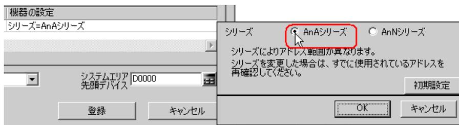
9 [ システムエリア機器 ] のリストボタンをクリックし、システムアドレスを割り当てる接続機器を選択します。( GP3000 シリーズ、WinGP および LT3000 の場合のみ )
