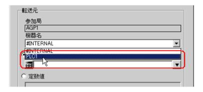
**3**[デバイスアドレス]をクリックしたあと、リストボタンをクリックし、データを読み出す接続機器「PLC1」のシンボル名「PLC1 データ」を選択します。
