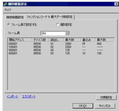
個別機器設定 dialog box, "ファンクションコード & 最大データ数設定" tab selected. Fields include: フレーム長 (254). A table shows frame details for addresses 000001 to 400001. Buttons: インポート, エクスポート, 初期設定, OK, キャンセル.
