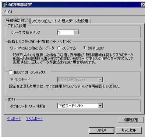
個別機器設定 dialog box, "接続機器設定" tab selected. Fields include: スレーブ番号アドレス (1), 保持レジスタへのビット操作 (クリアしない selected), アドレスモード (Dベース(デフォルト)), 変数 (ダブルワード・ワード単位 selected). Buttons: インポート, エクスポート, 初期設定, OK, キャンセル.
