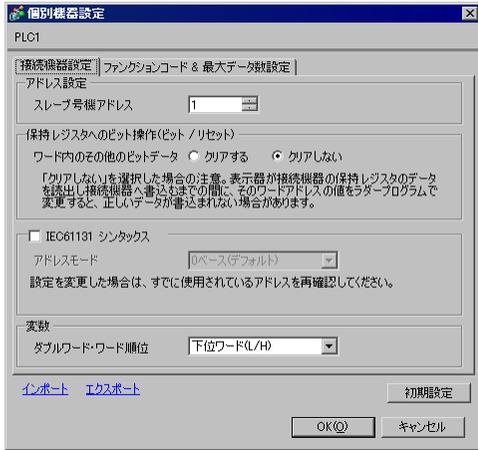
個別機器設定 dialog box, "接続機器設定" tab selected. Fields include: スレーブ番号アドレス (1), 保持レジスタへのビット操作 (クリアしない selected), アドレスモード (Dベース), 変数 (下位ワード(L/H)).
