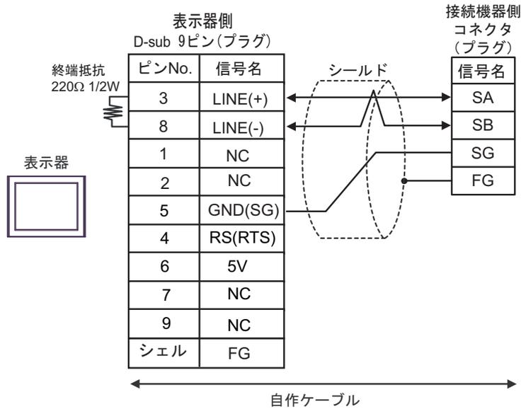
**重要** • 表示器の5V出力(6番ピン)はSiemens製PROFIBUSコネクタ用電源です。その他の機器の電源には使用できません。
