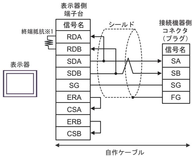
※1 表示器に内蔵している抵抗を終端抵抗として使用します。表示器背面のディップスイッチを以下のように設定してください。
