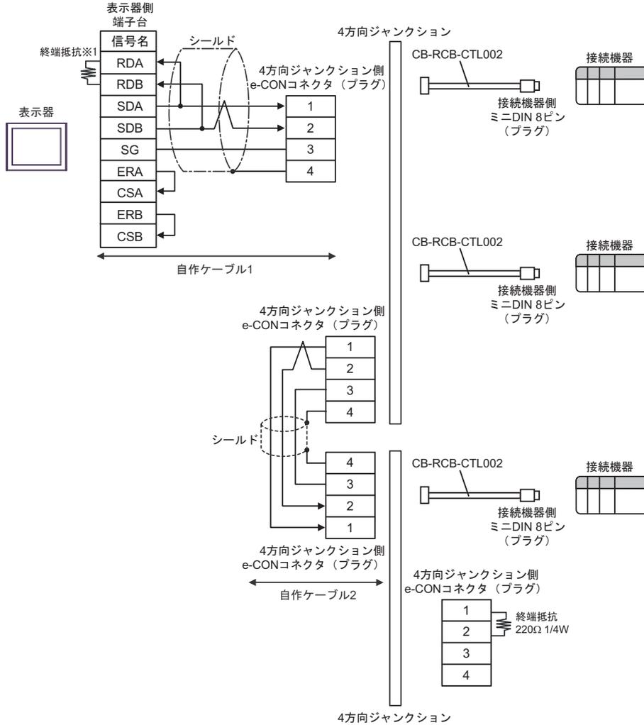
※1 表示器に内蔵している抵抗を終端抵抗として使用します。表示器背面のディップスイッチを以下のように設定してください。
