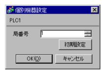
通信設定はラダーソフト (WinProladder) で行ないます。設定を行った後は、接続機器の電源を再投入して設定内容を有効にします。詳細は接続機器のマニュアルを参照してください。
