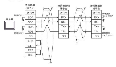
\*1 表示器に内蔵している抵抗を終端抵抗として使用します。表示器背面のディップスイッチを以下のように設定してください。
