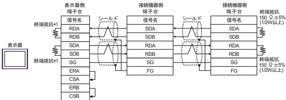
\*1 表示器に内蔵している抵抗を終端抵抗として使用します。表示器背面のディップスイッチを以下のように設定してください。
