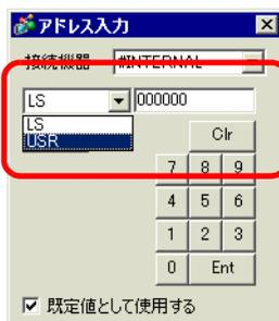
GP の内部デバイス [#INTERNAL] は、下図のように [LS] エリアと [USR] エリアの 2 つの領域で構成されています。
