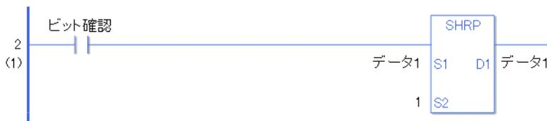
SHRP と SHR 命令の違いは、命令実行の検出に違いがあります。SHRP の場合、a 接点命令でも、ビット確認の ON の立ち上がりのみを検出して、SHRP 命令が実行されます。よって、ビット確認が ON し続けても、SHRP 命令は 1 スキャンのみ実行されます。
