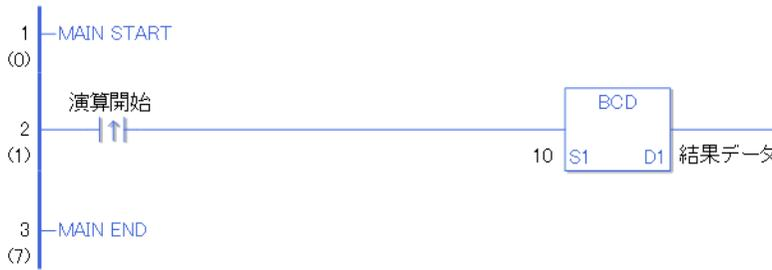
演算開始の立ち上がり検出接点命令が ON することによって、BCD 命令が実行されます。BCD 命令が実行されると D1 に設定している結果データに 10 (1010) を BCD 変換した結果、2 進数で 0001 0000 の値が結果データに格納される。演算開始が a 接点命令の場合は、演算開始が ON の間、常に BCD 命令が実行されます。
