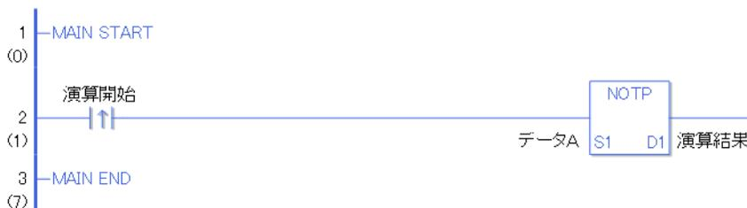
演算開始の a 接点命令が ON することによって、NOTP 命令が実行されます。NOTP 命令が実行されると D1 に設定している演算結果（整数変数）にデータ A の論理反転された結果値が格納されます。
