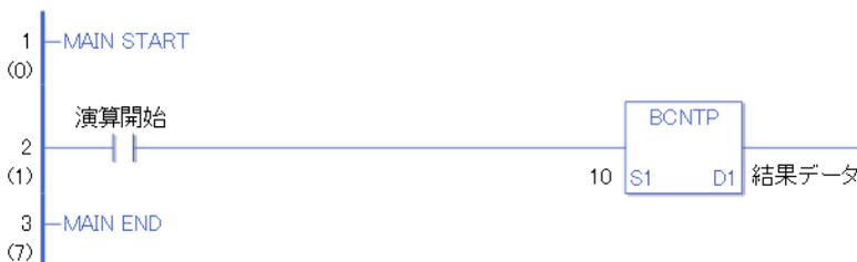
BCNTP と BCNT 命令の違いは、命令実行の検出に違いがあります。BCNTP の場合、a 接点命令でも、演算開始の ON の立ち上がりのみを検出して、BCNTP 命令が実行されます。よって、演算開始が ON し続けても、BCNTP 命令は 1 スキャンのみ実行されます。
