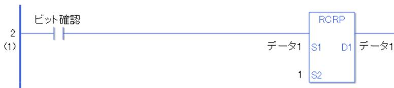
RCRP と RCR 命令の違いは、命令実行の検出に違いがあります。RCRP の場合、a 接点命令でも、ビット確認の ON の立ち上がりのみを検出して、RCRP 命令が実行されます。よって、ビット確認が ON し続けても、RCRP 命令は 1 スキャンのみ実行されます。
