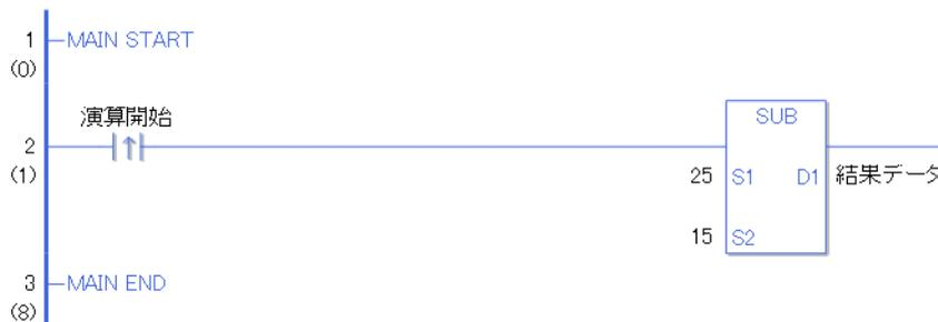
演算開始の立ち上がり検出接点命令が ON することによって、SUB 命令が実行されます。SUB 命令が実行されると D1 に設定している結果データ（整数変数）に  $25 - 15 = 10$  の結果値 10 が格納されます。
