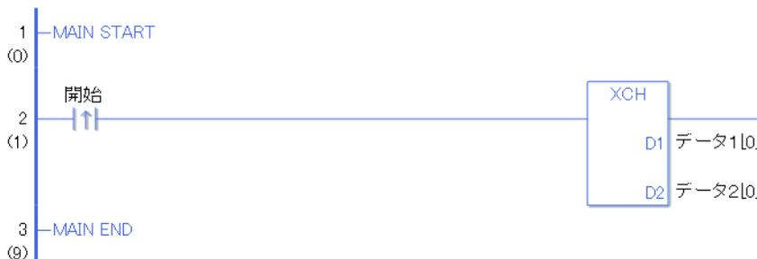
開始の立ち上がり検出接点命令が ON することによって、XCH 命令が実行されます。XCH 命令が実行されると D1 に設定しているデータ 1[0] と D2 に設定しているデータ 2[0] の内容を交換します。
