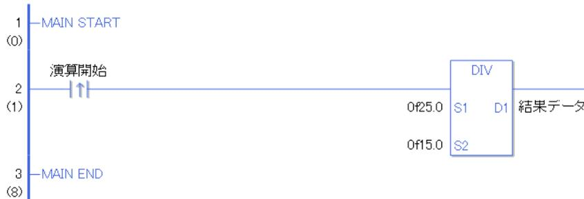
演算開始の立ち上がり検出接点命令が ON することによって、DIV 命令が実行されます。DIV 命令が実行されると D1 に設定している結果データ（フロート変数）に  $25 \div 15 = 1.66666\dots$  の結果値  $1.66666\dots$  が格納されます。割り切れない場合は、切捨てになります。
