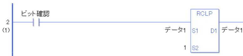
RCLP と RCL 命令の違いは、命令実行の検出に違いがあります。RCLP の場合、a 接点命令でも、ビット確認の ON の立ち上がりのみを検出して、RCLP 命令が実行されます。よって、ビット確認が ON し続けても、RCLP 命令は 1 スキャンのみ実行されます。
