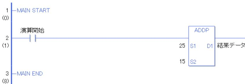
演算開始の a 接点命令が ON することによって、ADDP 命令が実行されます。ADDP 命令が実行されると D1 に設定している結果データ（整数変数）に  $25 + 15 = 40$  の結果値 40 が格納されます。
