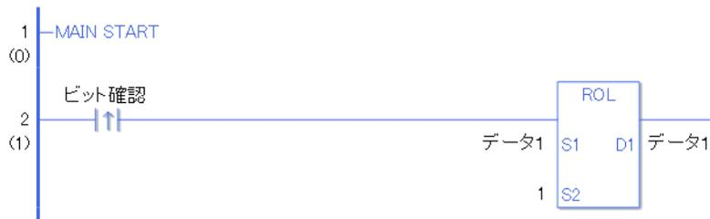
ビット確認の立ち上がり検出接点命令が ON することによって、ROL 命令が実行されます。ROL 命令が実行されると D1 に設定しているデータ 1（整数変数）に 1 ビットローテーションされた結果が格納されます。
