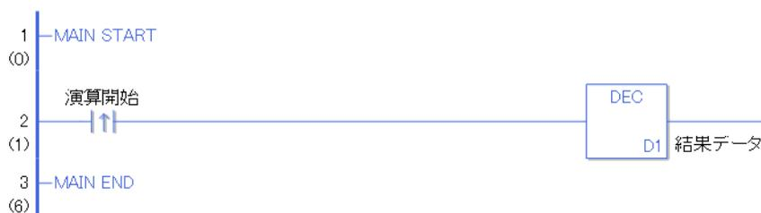
演算開始の立ち上がり検出接点命令が ON することによって、DEC 命令が実行されます。DEC 命令が実行されると D1 に設定している結果データ（整数変数）を 1 減算します。
