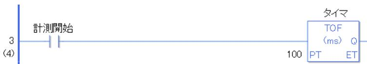
計測開始が ON (導通) すると、TOF 命令に起動がかかるために、経過時間 .ET が 0 にリセットされます。
