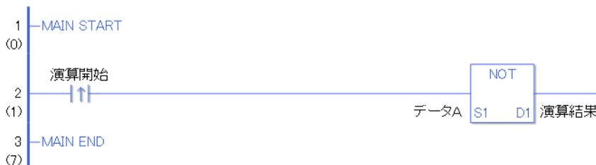
演算開始の立ち上がり検出接点命令が ON することによって、NOT 命令が実行されます。NOT 命令が実行されると D1 に設定している演算結果（整数変数）にデータ A の論理反転された結果値が格納されます。
