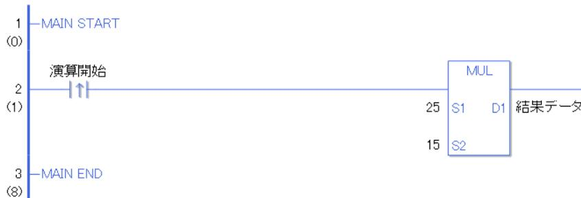
演算開始の立ち上がり検出接点命令が ON することによって、MUL 命令が実行されます。MUL 命令が実行されると D1 に設定している結果データ（整数変数）に  $25 \times 15 = 375$  の結果値 375 が格納されます。
