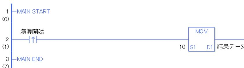
演算開始の立ち上がり検出接点命令が ON することによって、MOV 命令が実行されます。MOV 命令が実行されると D1 に設定している結果データに定数の 10 が格納されます。
