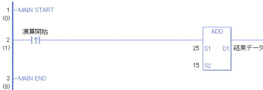
演算開始の立ち上がり検出接点命令が ON することによって、ADD 命令が実行されます。ADD 命令が実行されると D1 に設定している結果データ（整数変数）に  $25 + 15 = 40$  の結果値 40 が格納されます。
