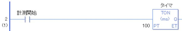
計測開始が ON (導通) すると、TON 命令に起動がかかるために、経過時間 .ET がタイムベースで設定された単位で増加します。
