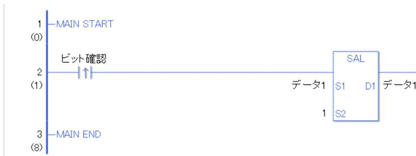
ビット確認の立ち上がり検出接点命令が ON することによって、SAL 命令が実行されます。SAL 命令が実行されると D1 に設定しているデータ 1（整数変数）に 1 ビット左シフトされた結果が格納されます。最上位ビットのみシフトせずに実行後の最上位ビットへそのまま格納され、最下位ビットは 0 が格納されます。
