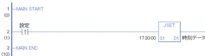
設定の立ち上がり検出接点命令が ON することによって、JSET 命令が実行されます。JSET 命令が実行されると D1 に設定している時刻データ（時刻変数）にダイアログで設定した 17 時 30 分 0 秒の時刻が格納されます。
