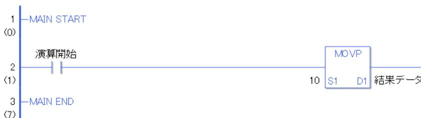
演算開始の a 接点命令が ON することによって、MOVP 命令が実行されます。MOVP 命令が実行されると D1 に設定している結果データ（整数変数）に定数の 10 が格納されます。
