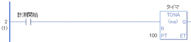
タイマが ON (導通) すると、TONA 命令に起動がかかるために、経過時間 .ET がタイムベースで設定された単位で増加します。
