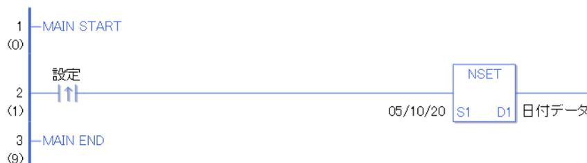
設定の立ち上がり検出接点命令が ON することによって、NSET 命令が実行されます。NSET 命令が実行されると D1 に設定している日付データ（日付変数）にダイアログで設定した 2005 年 10 月 20 日の日付が格納されます。
