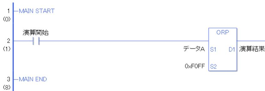
演算開始の a 接点命令が ON することによって、ORP 命令が実行されます。ORP 命令が実行されると D1 に設定している演算結果（整数変数）に データ A と F0FF の論理和の結果値が格納されます。
