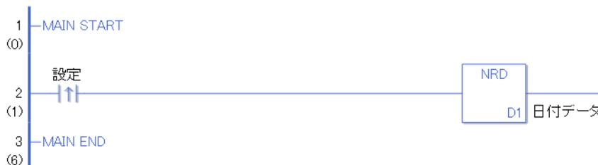
設定の立ち上がり検出接点命令が ON することによって、NRD 命令が実行されます。NRD 命令が実行されると D1 に設定している日付データ（日付変数）に現在の日付が格納されます。
