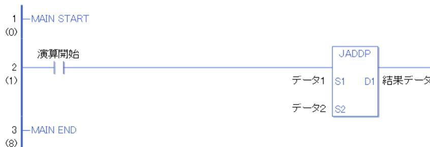
演算開始の a 接点命令が ON することによって、JADDP 命令が実行されます。JADDP 命令が実行されると S1 オペランドのデータ 1（時刻変数）と S2 オペランドのデータ 2（時刻変数）を加算し、D1 オペランドの結果データ（時刻変数）に、加算結果を格納します。演算開始が a 接点命令の場合でも、演算開始の ON の立ち上がりのみを検出して、JADDP 命令が実行されます。よって、演算開始が ON し続けても、JADDP 命令は 1 スキャンのみ実行します。
