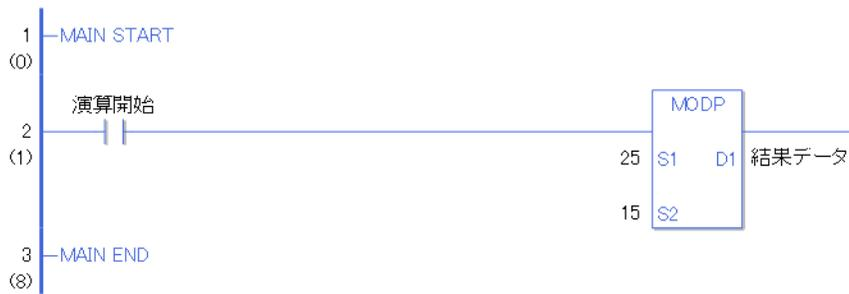
演算開始の a 接点命令が ON することによって、MODP 命令が実行されます。MODP 命令が実行されると D1 に設定している結果データ（整数変数）に  $25 \div 15 = 1$  余り 10 の結果値 10 が格納されます。
