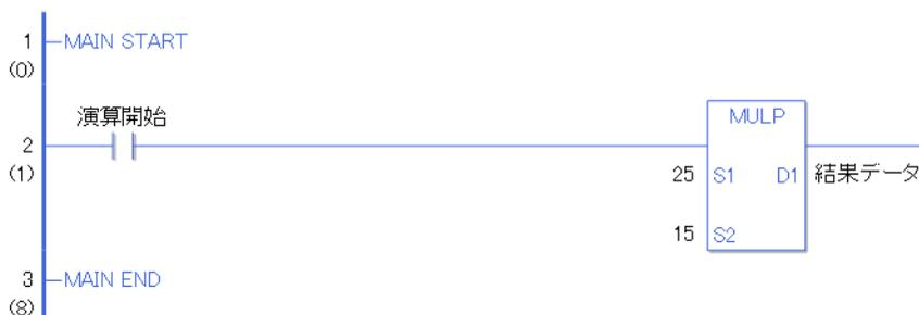
演算開始の a 接点命令が ON することによって、MULP 命令が実行されます。MULP 命令が実行されると D1 に設定している結果データ（整数変数）に  $25 \times 15 = 375$  の結果値 10 が格納されます。
