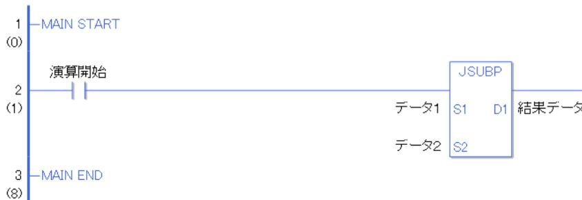
演算開始の a 接点命令が ON することによって、JSUBP 命令が実行されます。JSUBP 命令が実行されると S1 オペランドのデータ 1（時刻変数）から S2 オペランドのデータ 2（時刻変数）を減算し、D1 オペランドの結果データ（時刻変数）に、減算結果を格納します。演算開始が a 接点命令の場合でも、演算開始の ON の立ち上がりのみを検出して、JSUBP 命令が実行されます。よって、演算開始が ON し続けても、JSUBP 命令は 1 スキャンのみ実行します。
