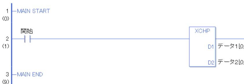
開始の立ち上がり検出接点命令が ON することによって、XCHP 命令が実行されます。XCHP 命令が実行されると D1 に設定しているデータ 1[0] と D2 に設定しているデータ 2[0] の内容を交換します。
