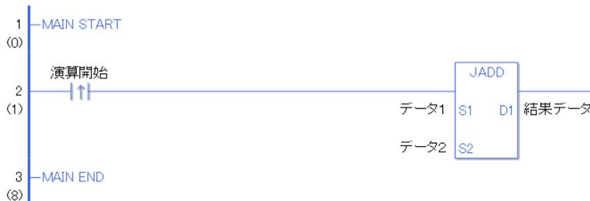
演算開始の立ち上がり検出接点命令が ON することによって、JADD 命令が実行されます。JADD 命令が実行されると S1 オペランドのデータ 1（時刻変数）と S2 オペランドのデータ 2（時刻変数）を加算し、D1 オペランドの結果データ（時刻変数）に、加算結果を格納します。演算開始が a 接点命令の場合は、演算開始が ON の間、常に JADD 命令が実行され 1 スキャン実行するたびに時刻加算を実行します。
