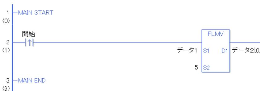
開始の立ち上がり検出接点命令が ON することによって、FLMV 命令が実行されます。FLMV 命令が実行されると D1 に設定しているデータ 2 に、データ 1 の内容をデータ 2 の 0 個目から 5 個分コピーします。
