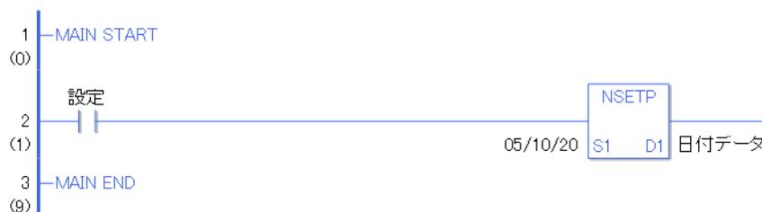
設定の a 接点命令が ON することによって、NSETP 命令が実行されます。NSETP 命令が実行されると D1 に設定している日付データ（日付変数）にダイアログで設定した 2005 年 10 月 20 日の日付が格納されます。
