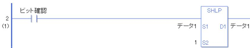
SHLP と SHL 命令の違いは、命令実行の検出に違いがあります。SHLP の場合、a 接点命令でも、ビット確認の ON の立ち上がりのみを検出して、SHLP 命令が実行されます。よって、ビット確認が ON し続けても、SHLP 命令は 1 スキャンのみ実行されます。
