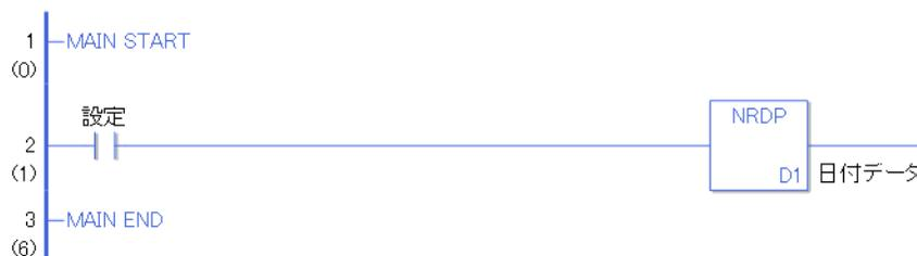
設定の a 接点命令が ON することによって、NRDP 命令が実行されます。NRDP 命令が実行されると D1 に設定している日付データ（日付変数）に現在の日付が格納されます。
