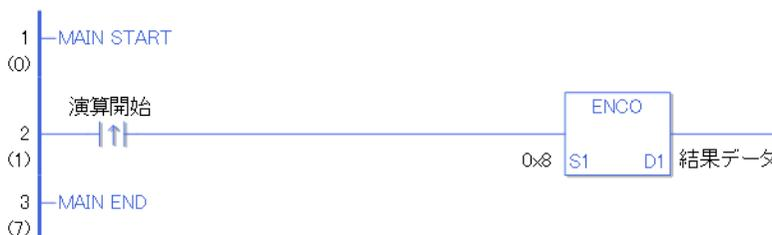
演算開始の立ち上がり検出接点命令が ON することによって、ENCO 命令が実行されます。ENCO 命令が実行されると D1 に設定している結果データに 0000 1000 (HEX で 8) を ENCO 変換した結果、2 進数で 0011 (3) の値が結果データに格納されます。演算開始が a 接点命令の場合は、演算開始が ON の間、常に ENCO 命令が実行されます。
