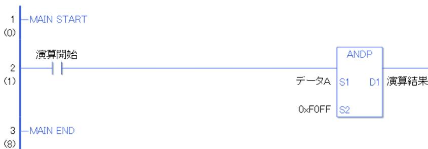
演算開始の a 接点命令が ON することによって、ANDP 命令が実行されます。ANDP 命令が実行されると D1 に設定している演算結果（整数変数）にデータ A と F0FF の論理積の結果値が格納されます。
