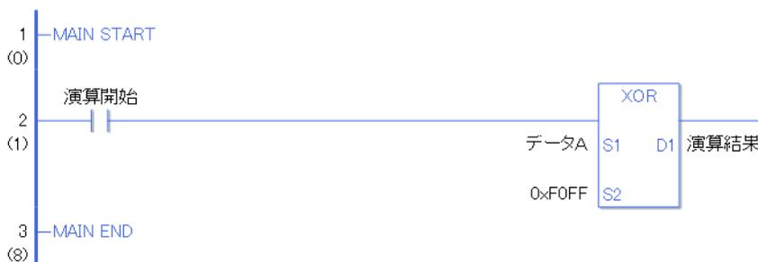
演算開始の立ち上がり検出接点命令が ON することによって、XOR 命令が実行されます。XOR 命令が実行されると D1 に設定している演算結果（整数変数）にデータ A と F0FF の排他的論理和の結果値が格納されます。
