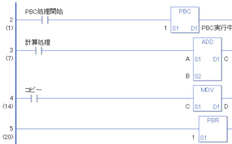
a 接点の PBC 処理開始が ON することによって、PBC 命令が実行されます。PBC 命令が実行されることによって、PBC と PBR 間のプログラムが実行されます。
