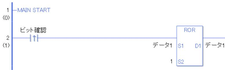
ビット確認の立ち上がり検出接点命令が ON することによって、ROR 命令が実行されます。ROR 命令が実行されると D1 に設定しているデータ 1（整数変数）に 1 ビット右ローテーションされた結果が格納されます。
