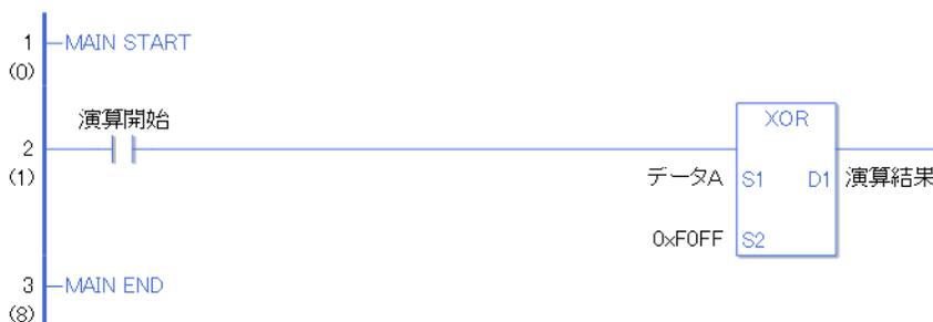
演算開始の a 接点命令が ON することによって、XORP 命令が実行されます。XORP 命令が実行されると D1 に設定している演算結果（整数変数）にデータ A と F0FF の排他的論理和の結果値が格納されます。
