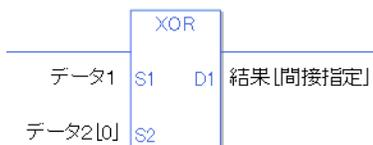
{ データ 1 = 1 Step } + { データ 2 [0] = 2 Step } + { 結果 [間接指定] = 3 Step } + { 1 Step } = 7 Step
