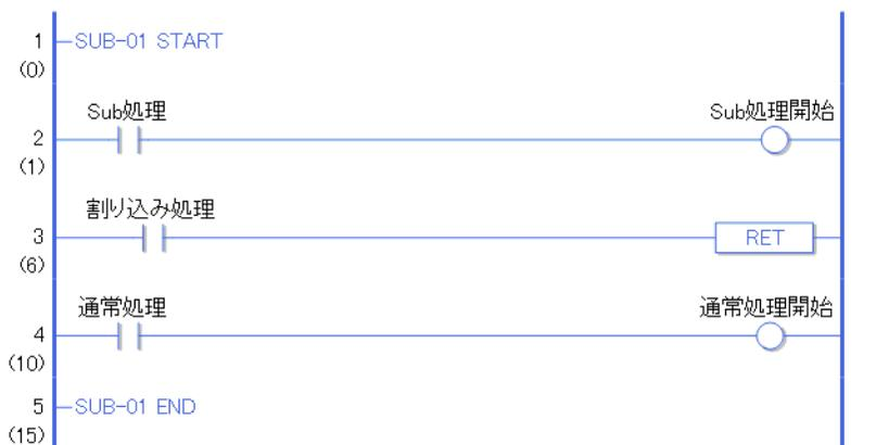
RET 命令はサブルーチンのみ使用可能です。MAIN からサブルーチン呼び出しの命令が実行され、サブルーチンプログラムに移行します。サブルーチン処理内に RET 命令ある場合、2 行目の処理を実行し、3 行目の処理で割り込み処理の a 接点が ON の場合、RET 命令が実行され、4 行目の処理を実行せずに、MAIN 処理に戻ります。
