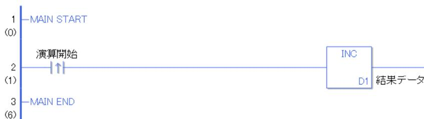
演算開始の立ち上がり検出接点命令が ON することによって、INC 命令が実行されます。INC 命令が実行されると D1 に設定している結果データ（整数変数）に 1 を加算します。
