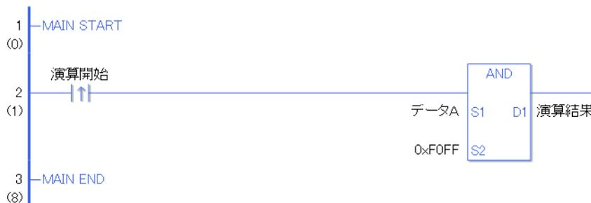
演算開始の立ち上がり検出接点命令が ON することによって、AND 命令が実行されます。AND 命令が実行されると D1 に設定している演算結果（整数変数）にデータ A と F0FF の論理積の結果値が格納されます。
