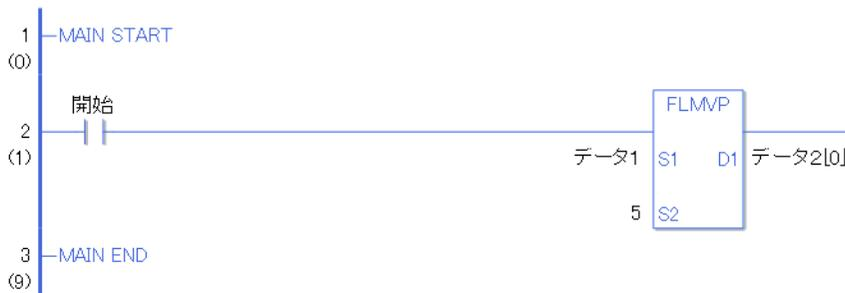
開始の a 接点命令が ON することによって、FLMVP 命令が実行されます。FLMVP 命令が実行されると D1 に設定しているデータ 2 に、データ 1 の内容をデータ 2 の 0 個目から 5 個分コピーします。
