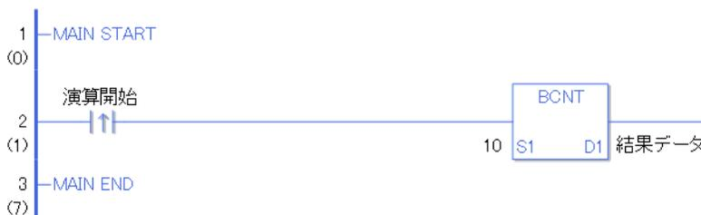
演算開始の立ち上がり検出接点命令が ON することによって、BCNT 命令が実行されます。BCNT 命令が実行されると D1 に設定している結果データに 10 (1010) の ON ビット数をカウントした結果値 2 が格納されます。
