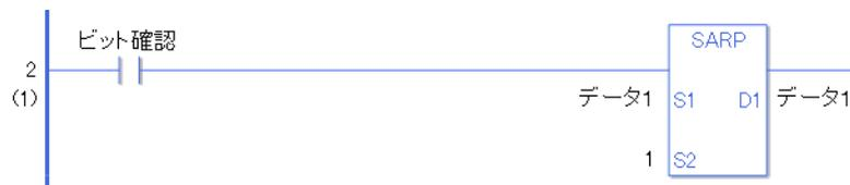
SARP と SAR 命令の違いは、命令実行の検出に違いがあります。SARP の場合、a 接点命令でも、ビット確認の ON の立ち上がりのみを検出して、SARP 命令が実行されます。よって、ビット確認が ON し続けても、SARP 命令は 1 スキャンのみ実行されます。
