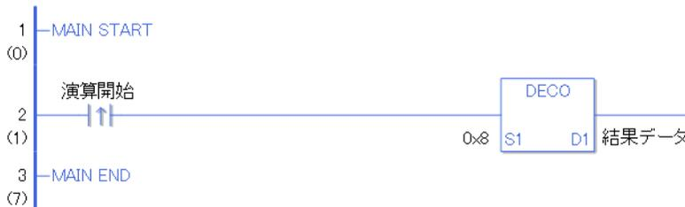
演算開始の立ち上がり検出接点命令が ON することによって、DECO 命令が実行されます。DECO 命令が実行されると D1 に設定している結果データに 0000 1000 (HEX で 8) を DECO 変換した結果、2 進数で 1 0000 0000 (8) の値が結果データに格納されます。
