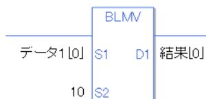
{ データ 1[0] = 2 Step } + { 10 = 1 Step } + { 結果 [0] = 2 Step } + { 1 Step } = 6 Step
