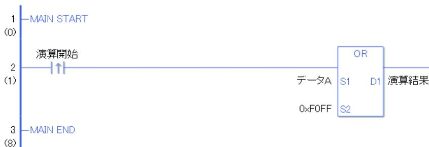
演算開始の立ち上がり検出接点命令が ON することによって、OR 命令が実行されます。OR 命令が実行されると D1 に設定している演算結果（整数変数）にデータ A と F0FF の論理和の結果値が格納されます。
