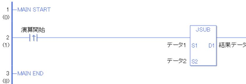
演算開始の立ち上がり検出接点命令が ON することによって、JSUB 命令が実行されます。JSUB 命令が実行されると S1 オペランドのデータ 1（時刻変数）から S2 オペランドのデータ 2（時刻変数）を減算し、D1 オペランドの結果データ（時刻変数）に、減算結果を格納します。演算開始が a 接点命令の場合は、演算開始が ON の間、常に JSUB 命令が実行され 1 スキャン実行するたびに時刻減算を実行します。
