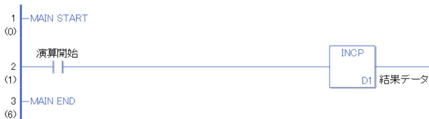
演算開始の a 接点命令が ON することによって、INCP 命令が実行されます。INCP 命令が実行されると D1 に設定している結果データ（整数変数）に 1 を加算します。
