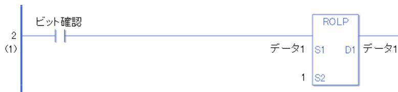
ROLP と ROL 命令の違いは、命令実行の検出に違いがあります。ROLP の場合、a 接点命令でも、ビット確認の ON の立ち上がりのみを検出して、ROLP 命令が実行されます。よって、ビット確認が ON し続けても、ROLP 命令は 1 スキャンのみ実行されます。
