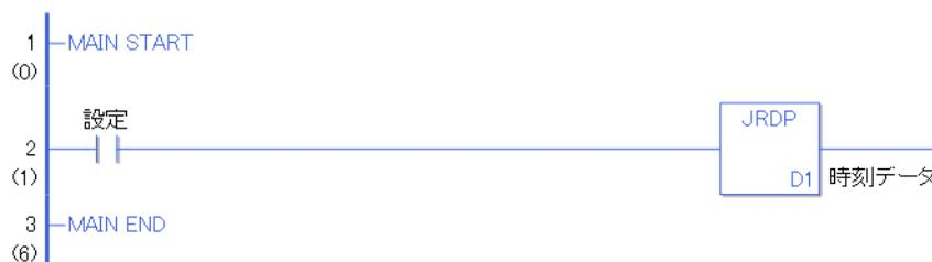
設定の a 接点命令が ON することによって、JRDP 命令が実行されます。JRDP 命令が実行されると D1 に設定している時刻データ（時刻変数）に現在の時刻が格納されます。
