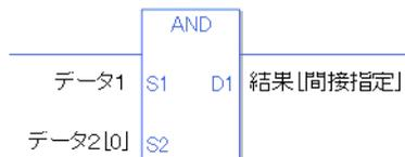
{ データ 1 = 1 Step } + { データ 2 [0] = 2 Step } + { 結果 [間接指定] = 3 Step } + { 1 Step } = 7 Step となります。最後の 1 Step は命令に対する Step 数です。必ず 1 Step 加算してください。
