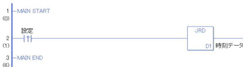
設定の立ち上がり検出接点命令が ON することによって、JRD 命令が実行されます。JRD 命令が実行されると D1 に設定している時刻データ（時刻変数）に現在の時刻が格納されます。
