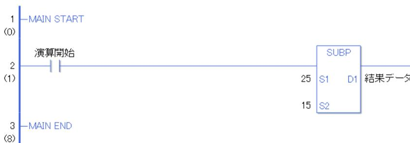
演算開始の a 接点命令が ON することによって、SUBP 命令が実行されます。SUBP 命令が実行されると D1 に設定している結果データ（整数変数）に  $25 - 15 = 10$  の結果値 10 が格納されます。
