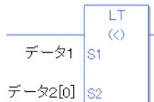
$$\{ \text{データ 1} = 1 \text{ Step} \} + \{ \text{データ 2 [0]} = 2 \text{ Step} \} + \{ 1 \text{ Step} \} = 4 \text{ Step}$$
