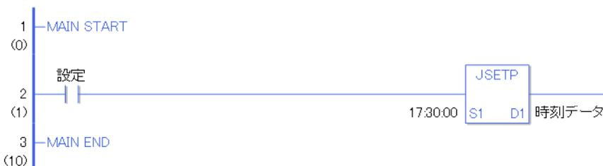
設定の a 接点命令が ON することによって、JSETP 命令が実行されます。JSETP 命令が実行されると D1 に設定している時刻データ（時刻変数）にダイアログで設定した 17 時 30 分 0 秒の時刻が格納されます。
