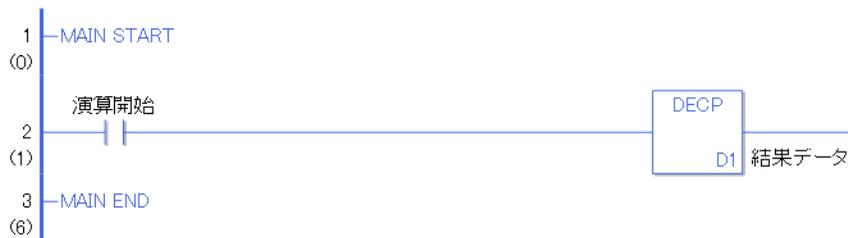
演算開始の a 接点命令が ON することによって、DECP 命令が実行されます。DECP 命令が実行されると D1 に設定している結果データ（整数変数）を 1 減算します。
