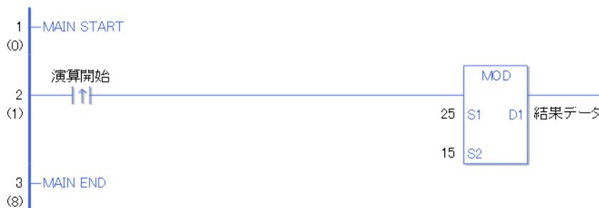
演算開始の立ち上がり検出接点命令が ON することによって、MOD 命令が実行されます。MOD 命令が実行されると D1 に設定している結果データ（整数変数）に  $25 \div 15 = 1$  余り 10 の結果値 10 が格納されます。
