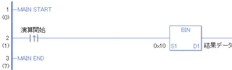
演算開始の立ち上がり検出接点命令が ON することによって、BIN 命令が実行されます。BIN 命令が実行されると D1 に設定している結果データに 0001 0000 (HEX で 10) を BIN 変換した結果、2 進数で 1010 の値が結果データに格納されます。演算開始が a 接点命令の場合は、演算開始が ON の間、常に BIN 命令が実行されます。
