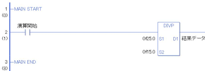
演算開始の a 接点命令が ON することによって、DIVP 命令が実行されます。DIVP 命令が実行されると D1 に設定している結果データ（フロート変数）に  $25 \div 15 = 1.66666\dots$  の結果値  $1.66666\dots$  が格納されます。割り切れない場合は、切捨てになります。
