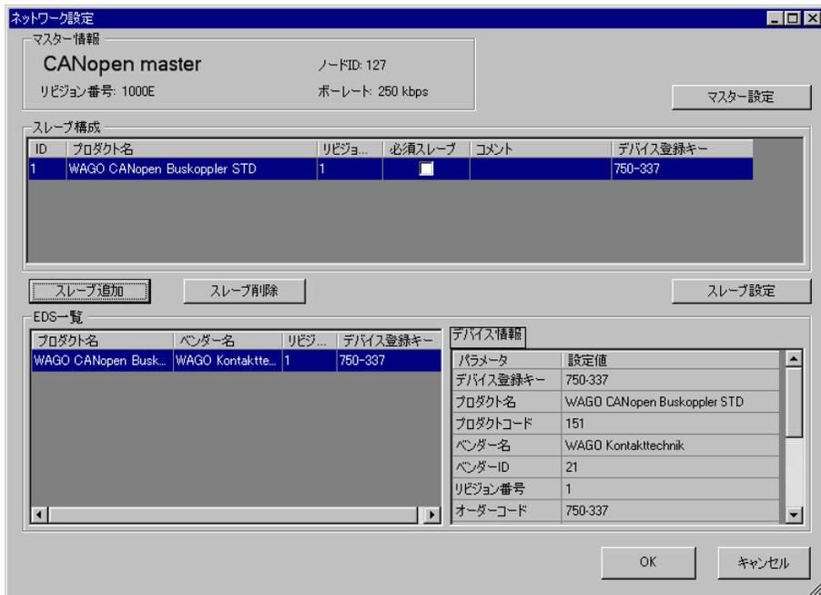
9 追加したスレーブユニットを選択した状態で [スレーブ設定] をクリックすると、次のダイアログボックスが表示されます。使用したい機能に応じて通信パラメータの設定を行い、使用するオブジェクトの動作や値を設定します。[OK] をクリックすると設定が有効になり、ダイアログボックスが閉じます。
