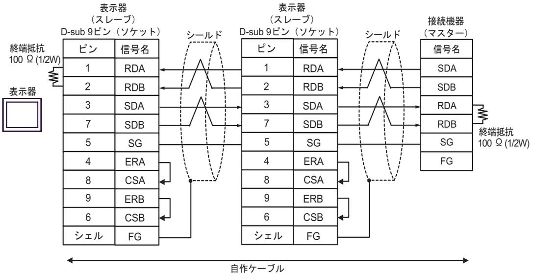
C. (株) デジタル製オンラインアダプタ (CA4-ADPONL-01)、(株) デジタル製コネクタ端子台変換アダプタ (CA3-ADPTRM-01) および自作ケーブルを使用する場合
