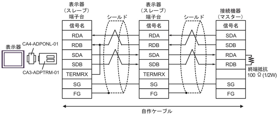
D. (株) デジタル製オンラインアダプタ (CA4-ADPONL-01) および自作ケーブルを使用する場合
