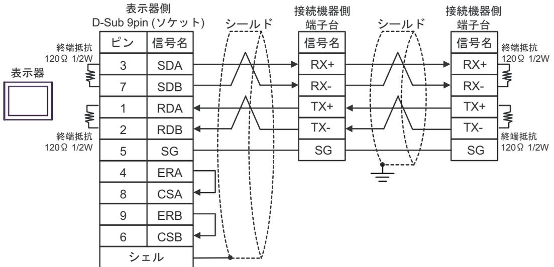
C) (株) デジタル製オンラインアダプタ (CA4-ADPONL-01) (株) デジタル製コネクタ端子台変換アダプタ (CA3-ADPTRM-01) および自作ケーブルを使用する場合
