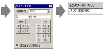
5 [ データ形式 ] で表示するデータの形式 (例「16 ビット Dec 」) を設定します。
