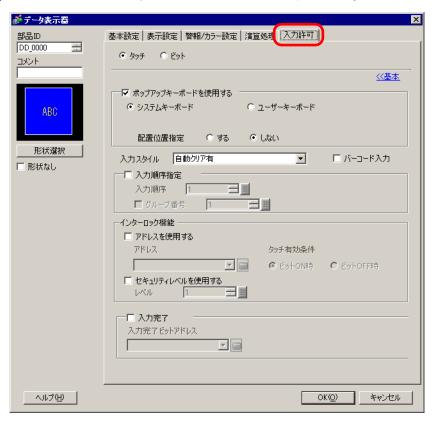
8 [インターロック機能]で[アドレスを使用する]にチェックを入れ[アドレス]に入力を許可する タッチの有効条件となるビットアドレス(M100)を設定します。
