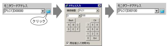
6 モニタワードアドレスから表示文字数分使用するワードアドレスの最後尾のアドレスが表示されます。
