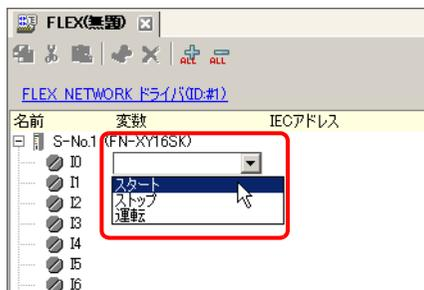
3 [Enter] キーを押すと、アドレスが割り付けられ、I/O アドレス (IEC アドレス) が表示されます。
