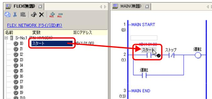
2 アドレスが割り付けられ、I/O アドレス (IEC アドレス) が表示されます。
