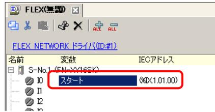
ロジックプログラムから各 I/O 端子へドラッグ&ドロップして割り付けする
