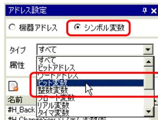
3 [タイプ] が [ビット変数] のアドレスのみが表示されます。一覧から [スタート] をクリックし、マウスの左ボタンを押したまま割り付けたい命令のオペラント部分までドラッグします。
