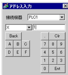
接続機器とデバイスを選択し、アドレスを入力して「Ent」キーを押します。
