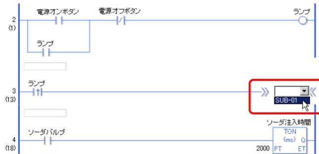
「ランプ」が ON を検出したとき、サブルーチンプログラム [SUB-01] にジャンプします。サブルーチン [SUB-01] の実行終了後、メインロジックプログラム [MAIN] の 4 行目から実行を再開します。
