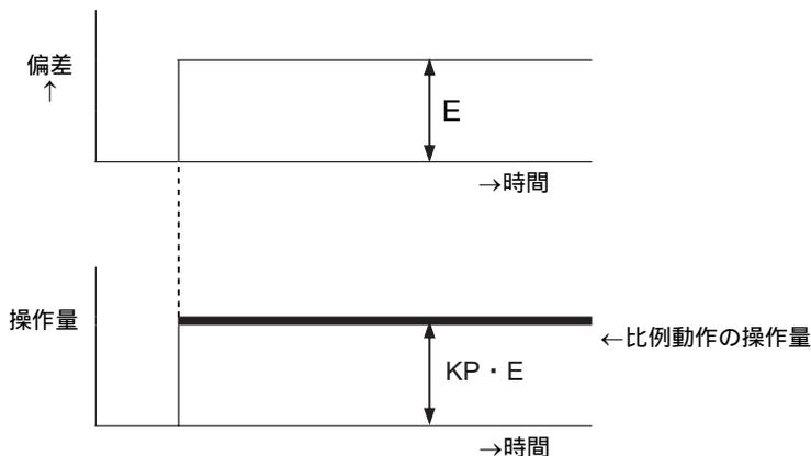
操作量は、0 ~ 4095 (初期値) の間で変化し、KP が大きくなるにつれて同一偏差に対する操作量が大きくなり、修正動作は強くなります。また、比例動作では、オフセット (残留偏差) が生じます。
