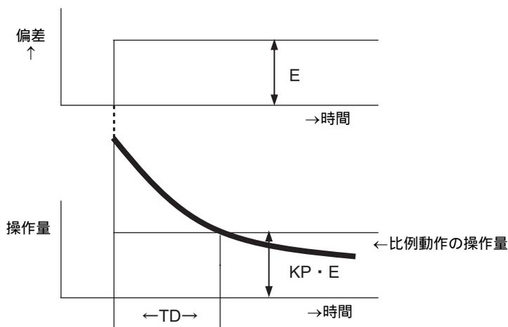
微分動作は、比例動作と組み合わせた「PD動作」や比例動作と積分動作と組み合わせた「PID動作」として使用します。微分動作だけの使用はできません。
