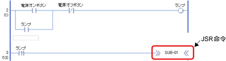
サブルーチン画面 [SUB-01] ↓ メインプログラム 3 行目実行後、JSR 命令によりサブルーチンプログラム [SUB-01] へジャンプします。
