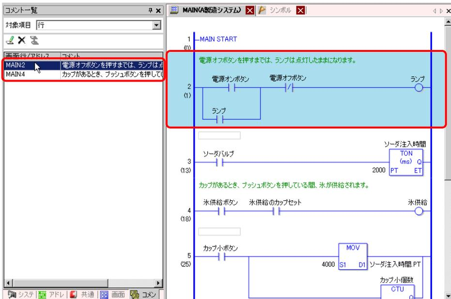
6 [対象項目] が [変数] または [システム変数] の場合、[画面:行/アドレス] の列のセルをダブルクリックすると、[アドレス設定] ウィンドウが表示され、対象のシンボル変数またはシステム変数が選択されます。
