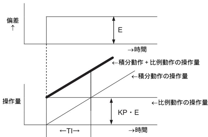
積分動作は、比例動作と組み合わせた「PI 動作」や比例動作と微分動作と組み合わせた「PID 動作」として使用します。積分動作だけの使用はできません。
