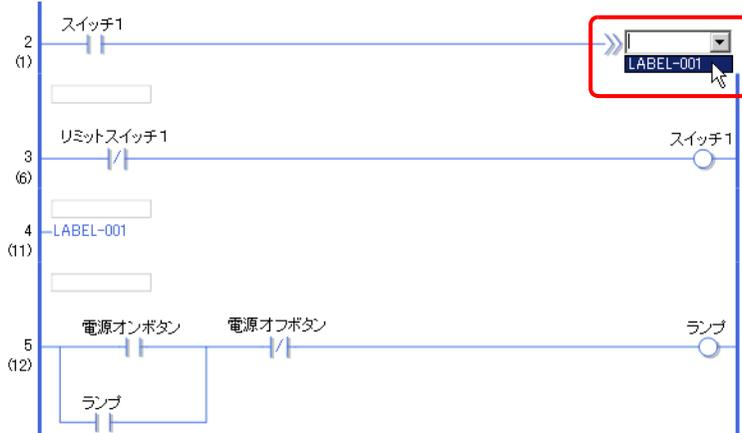
JMP 命令「LABEL-001」が検出されたとき、ラベル [LABEL-001] にジャンプします。ラベル [LABEL-001] の実行終了後、そのまま次の行からロジックプログラムが実行されます。
