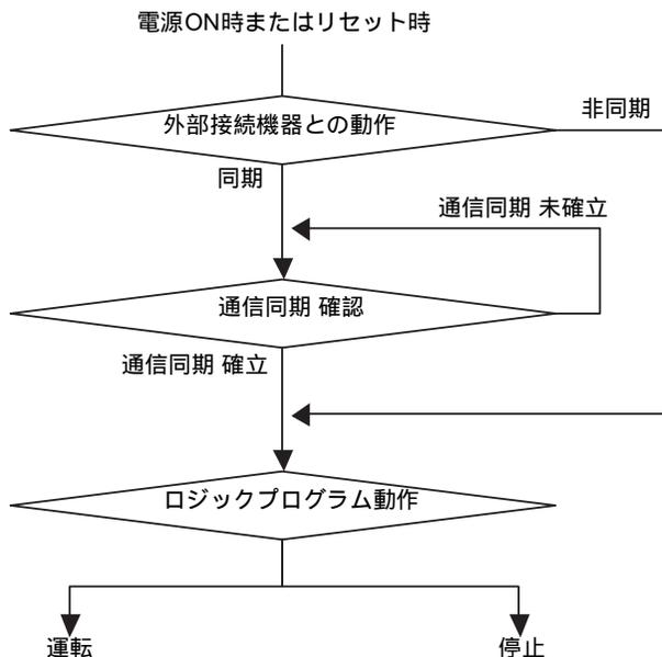
[外部接続機器との動作]が[同期]の場合、通信同期が確立されているかを確認します。
