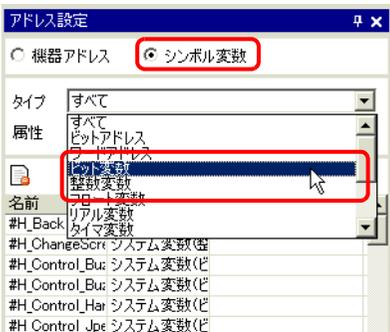
3 [タイプ] が [ビット変数] のシンボル変数のみが表示されます。一覧から [電源オンボタン] をクリックし、マウスの左ボタンを押したまま割り付けたい命令のオペランド部分までドラッグします。カーソルが
