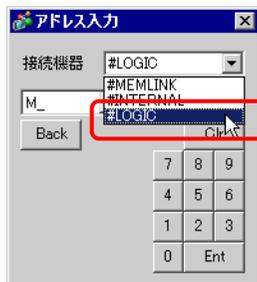
5 ロジックアドレスが表示されます。ロジックプログラムの命令や画面に配置した部品にドラッグ&ドロップして、アドレスを設定してください。
