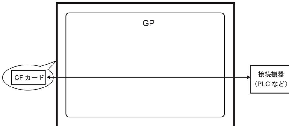
CSV データの転送方法には、接続機器からコントロールする方法（自動転送）と、GP 画面上からタッチでコントロールする方法（手動転送）の 2 種類あります。
