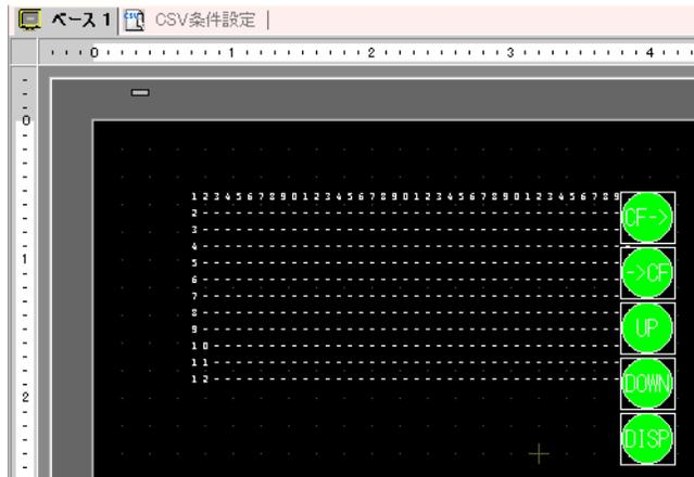
9 配置した特殊データ表示器をダブルクリックすると、設定ダイアログボックスが開きます。
