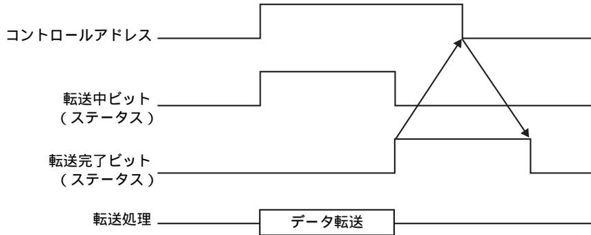
転送に失敗した場合は、転送中ビットが OFF し、エラーステータス（ステータスのビット 12 ~ 15）にエラーコードがセットされます。コントロールアドレス、ステータスのビットをすべて「0」に戻してから次の転送を行ってください。
