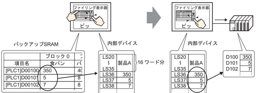
内部デバイスに格納されたデータは、必要に応じてデータ表示器 [ 数値表示 ] を使用して GP 画面に表示できます。接続機器に転送する前に GP 画面上でデータを微調整してから転送したい場合などに使用します。
