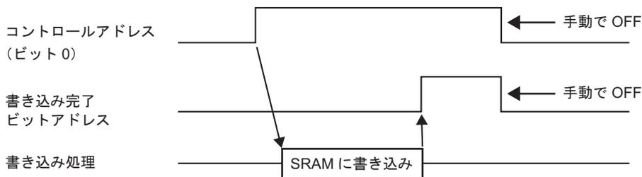
バックアップ SRAM に転送できなかった場合 (SRAM の空き容量が不足していた場合など) は、内部デバイス (特殊リレーエリア) の LS2032 のビット 9 が ON します。再度転送を行う場合は、[コントロールワードアドレス] のビット 0 を一旦 OFF し、通信サイクルタイムもしくは 150ms のいずれが長いほうの時間をあけてから ON してください。
