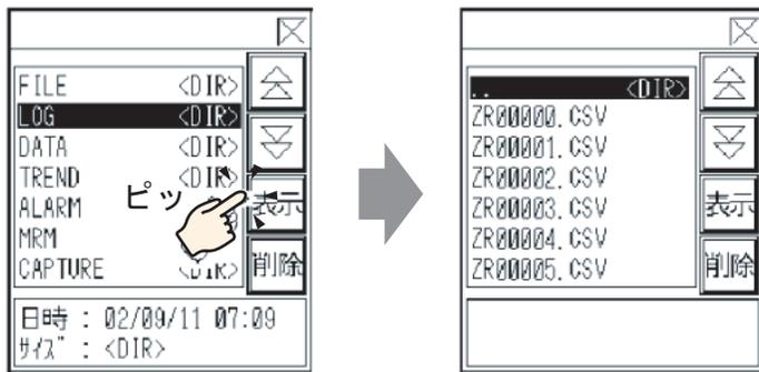
**MEMO** • ファイルを一覧表示しているページから前の階層（フォルダの一覧）に戻るには、最初の行にある「.. < DIR >」を選択して [表示] キーをタッチします。
