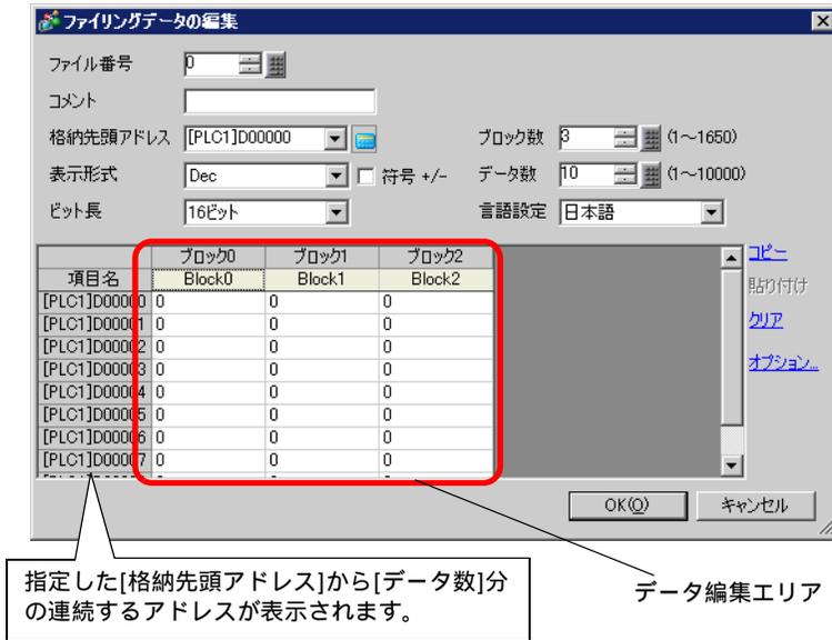
4 [格納先頭アドレス] に、転送先(または転送元)となる接続機器の先頭アドレスを設定します。指定した内容でデータ編集エリアが構成されます。
