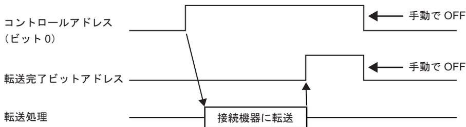
接続機器とバックアップ SRAM 間の転送ができなかった場合（通信エラーが発生した場合など）には、内部デバイス（特殊リレーエリア）の LS2032 のビット 10 が ON します。再度転送を行う場合は、[コントロールワードアドレス] のビット 0 を一旦 OFF し、通信サイクルタイムもしくは 150ms のいずれか長いほうの時間をおいてから ON してください。
