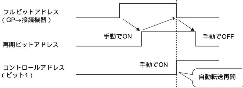
**MEMO** • GPの電源ON時にすでにCFカード内に[終了番号]までファイルが存在していると、[コントロールワードアドレス]のビット1をONした直後に[フルビットアドレス]がONされ、転送処理が実行されません。そのとき[再開ビットアドレス]がONしていた場合は、[コントロールワードアドレス]のビット1をONすると[先頭番号]のファイルが上書きされます。転送を行う前に必ずCFカードに保存されているファイル番号と[再開ビットアドレス]の状態を確認してください。
