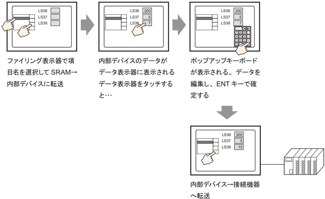
内部デバイスに格納されたファイリングデータの構造
