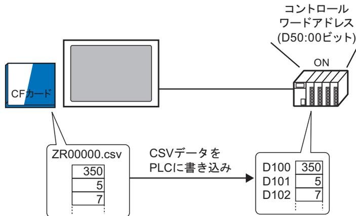
またコントロールアドレスのビット 1 を ON すると、あらかじめ設定した転送条件 (転送元アドレスやデータ数など) に従って接続機器のデータを読み出し、新たな CSV データとして CF カードへ保存します。
