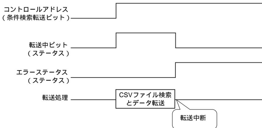
**MEMO** ・ 転送中ビット ON 時には、CSV ファイル検索時間も含まれます。そのため、転送中ビットが ON している間は、CF カードの [FILE] フォルダへはアクセスしないでください。
