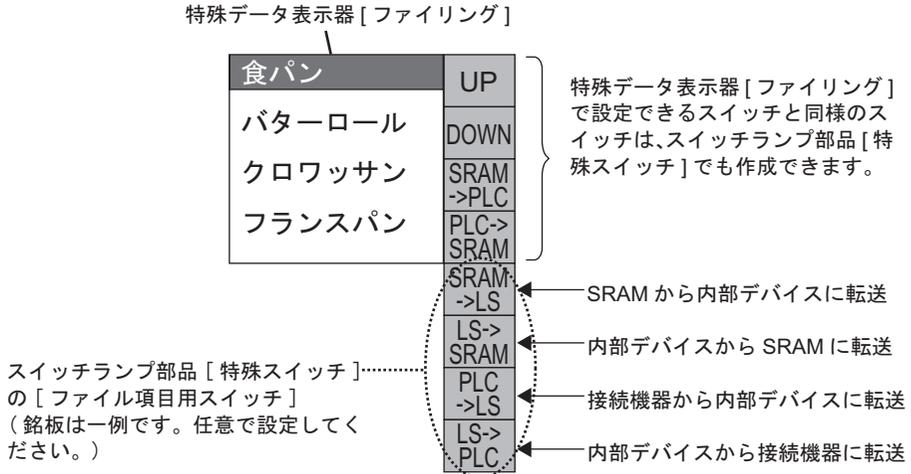
**MEMO** ・ 内部デバイスへの転送、内部デバイスからの転送を操作するスイッチは、スイッチランプ部品 [ 特殊スイッチ ] でのみ作成できます。
