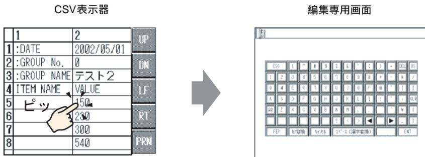
編集用画面のキーボードでデータを編集してから [ENT] キーをタッチすることで編集内容が確定され、編集用画面が閉じられます。
