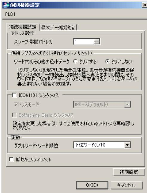
個別機器設定 dialog box (PLC1) showing the '接続機器設定' tab. The 'アドレス設定' section includes a 'スレーブ号機アドレス' field with the value '1'. Below it are options for '保持レジスタへのビット操作(セット/リセット)' with radio buttons for 'クリアする' and 'クリアしない'. There are checkboxes for 'IEC61131 シンタックス' and 'SoMachine Basic シンタックス'. The 'アドレスモード' is set to '0ベース(デフォルト)'. The '変数' section has a 'ダブルワード・ワード順位' dropdown set to '下位ワード(L/H)'. There is also a checkbox for '低セキュリティレベル'. Buttons for '初期設定', 'OK(O)', and 'キャンセル' are at the bottom.
