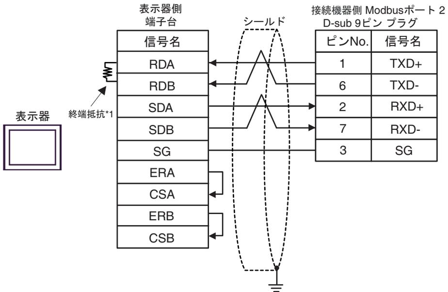
\*1 表示器に内蔵している抵抗を終端抵抗として使用します。表示器背面のディップスイッチを以下のように設定してください。
