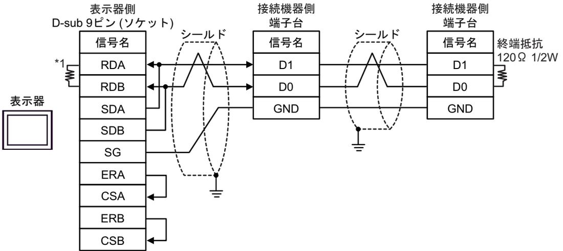
\*1 表示器に内蔵している抵抗を終端抵抗として使用します。表示器背面のディップスイッチを以下のように設定してください。
