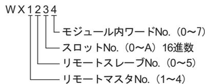
※4 光リモート通信モジュールを使用する場合は次のように指定します。
