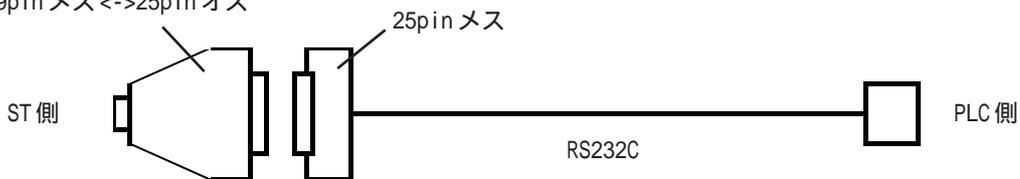
D-sub25 ピンオス <-> D-sub9 ピンメス変換アダプタ仕様
