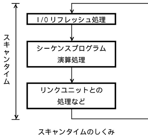
上図の“リンクユニットとの処理”で、PLCはGPからのコマンドに対する処理を行っています。GPからのコマンドは、処理が完了するまでに1～数スキャンタイムかかります。
