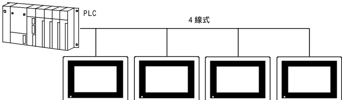
複数台のGPをPLC一台に接続し、ダイレクトアクセス方式のn:1 (マルチリンク) 通信を実現することができます。
