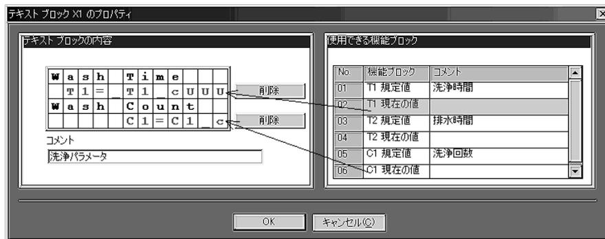
5. 手順1、2と同様にして、ラングNo.10にZキー接点「Z2」、テキストコイル「TX1」を配置します。テキストコイル「TX1」上で右クリックして "リセット入力" を選択します。
